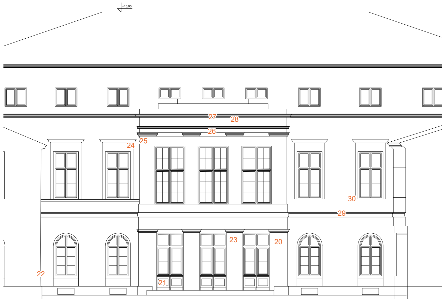
Nacrt zapadnog pročelja s upisanim pozicijama sondiranja
